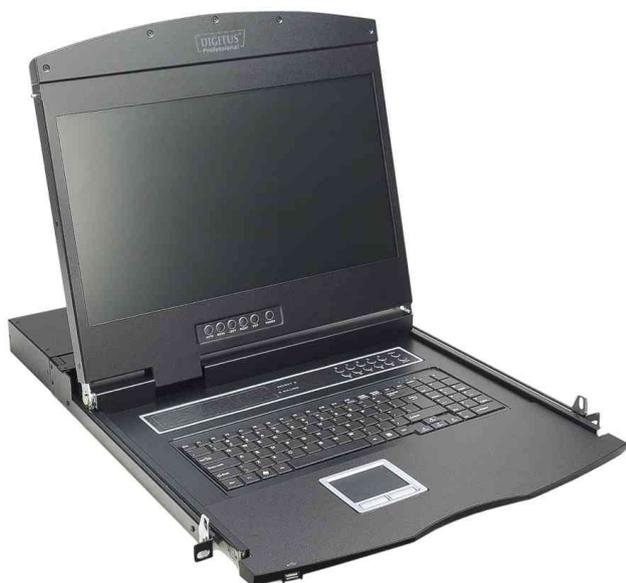
19" Modulare Konsole mit KVM Switch 8-Port, Vorderseite
