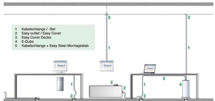
zeigt die Verkabelungsmöglichkeiten der Kabelschlange
