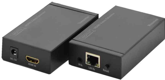
HDMI Video Extender über Kat.5 mit IR-Steuerung
