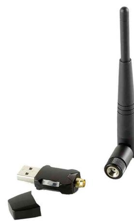
WLAN Dual-Band USB 2.0 Adapter, Detailsicht
