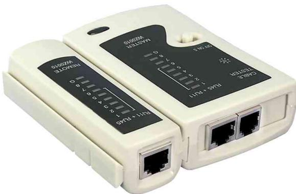
Kabeltester für RJ11, RJ12, RJ45
